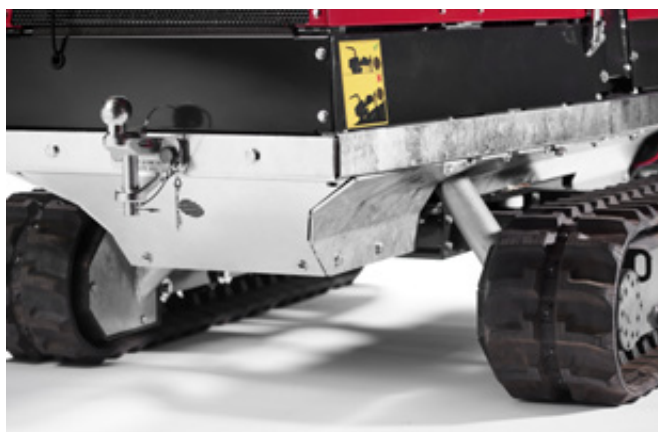
Marknadens högsta markfrigång: 200 mm, enkel service och solid slangkåpa. Variabel bandbredd 1 150-1 350 mm
