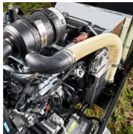
Hatz 4H50 Stage V motor med 55 kW
